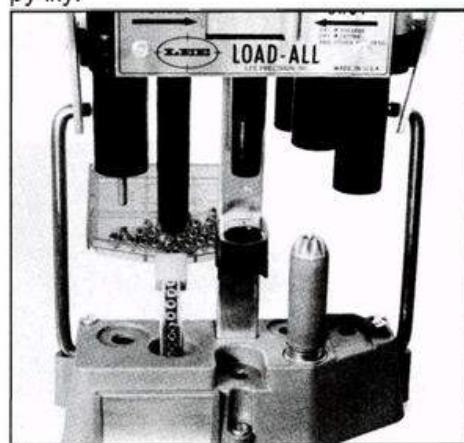
**СТАНЦИЯ 4** Поместите гильзу под соответствующий стартер-обжиматель. Держите внутренний сгиб края гильзы вперед для правильного совмещения со стартером-обжимателем. Полностью поднимите ручку. Для некоторых гильз может понадобиться две секунды для усадки пластика.
