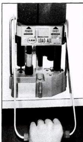
**СТАНЦИЯ 2** Поместите капсюль в капсюльное гнездо СТАНЦИИ 2. Переместите гильзу на СТАНЦИЮ 2; потяните за ручку. Калибровочное кольцо на этой станции сбрасывается автоматически. Снимите его с гильзы.
